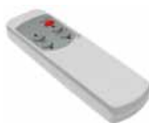
CT – Control total Concebido para todos los modelos, desde OPTIMA a MAX (excepto MINIBEL y ECO). Accesorios: sensor anti-congelación, contacto de puerta, termostato ambiente, etc...Programador horario permite tres ON/OFF diferentes para cada día de la semana.Display digital indicador de hora, velocidad de ventilación, etapa de calefacción, temperatura actual y de consigna... Display multilingüe, 9 idiomas a elegir. Funcionamiento manual o automático con diferentes programas disponibles.
