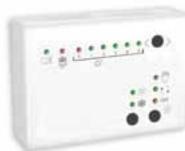
D-805 Hand/Auto (Opcional) Controlador agua, funcionamiento manual o automático Funciones auxiliares: sensor anticongelación, contacto de puerta y termostato ambiente
